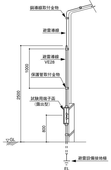
●引下げ導体を外壁に露出で引下げる場合は、GLから2.5Mまでは機械的に保護する。
