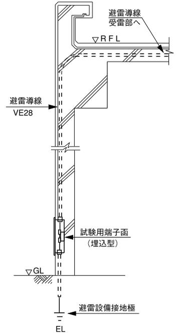
●鉄骨、鉄筋を引下げ導線にする場合は、2箇所以上引き下げる。
